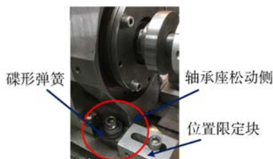
图 3 轴承座单侧松动状态图
